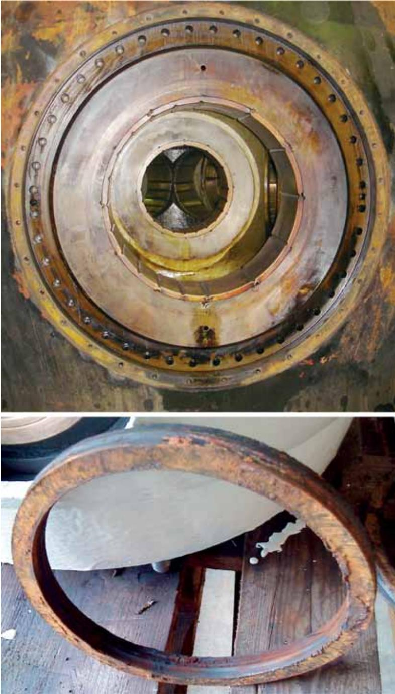
Abb. 3: Obwohl selbstschmierende Gleitlager in ölgefüllten Laufnaben oft als unnötig gelten, hat Federal-Mogul Deva immer wieder bei Instandsetzungsprojekten Spuren deutlich erhöhter Reibung und von Verschleiß durch Mischreibung und/oder Festkörperkontakt gefunden. Bei dem gezeigten Beispiel hatte sich das alte Bronzelager deshalb in der Aufnahme bewegt.
